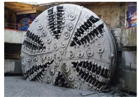
Bild 1a: Begehbare Schneidrad Ø 13,7m des Mixschilds nach dem Durchstich des Eurasia-Tunnels Istanbul
