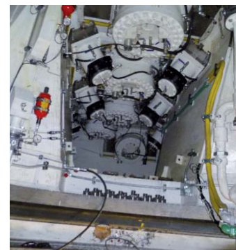
Bild 1a: Begehbare Schneidrad Ø 13,7m des Mixschilds nach dem Durchstich des Eurasia-Tunnels Istanbul
