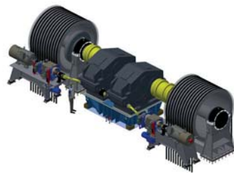
Antrieb der neuen Bahnbrücke Kattwyk in Hamburg
