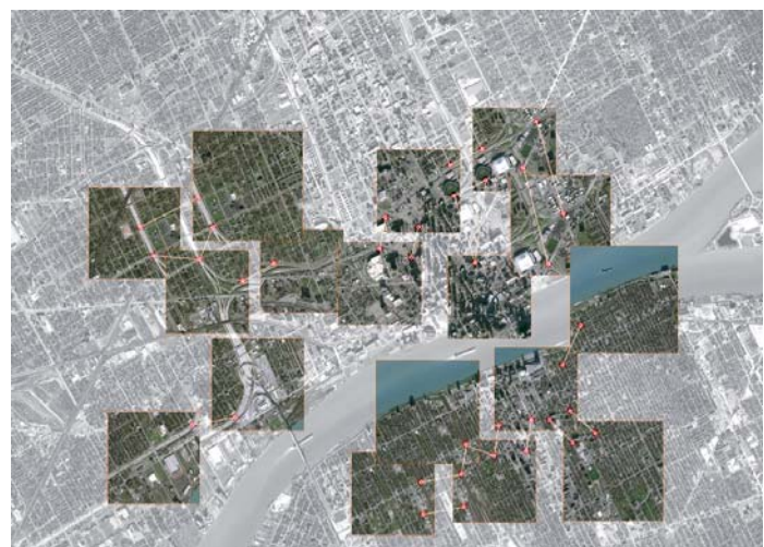
Abb.7: Referenzierung von Einzelsatellitenszenen basierend auf abgeleiteten Passpunkten zu einem paasgenauen Bildmosaik entlang eines Flusses.
