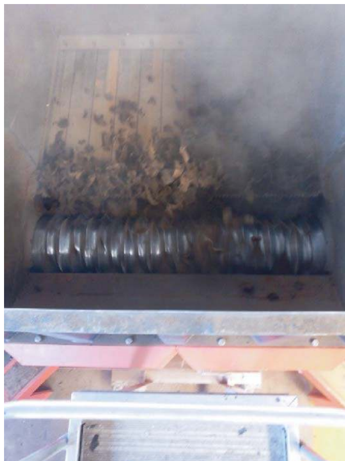
Abb. 2: Staubentwicklung während der trockenen mechanischen Zerkleinerung ungewaschener Geotextilien verursacht durch anhaftendes Sediment.
