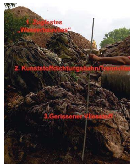
Abb. 1: Gebrauchte Geotextilien auf einer WSV Baustelle.
