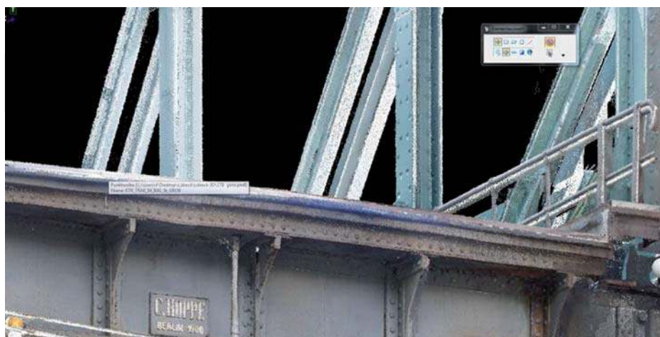
Abb. 4: Endquerträger Straßenhubbrücke als 3D-Punktwolke
