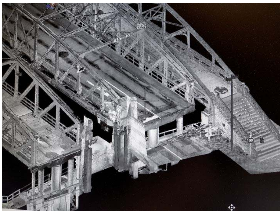
Abb. 3: Auszug aus der 3D-Punktwolke Hubbrückenensemble Lübeck
