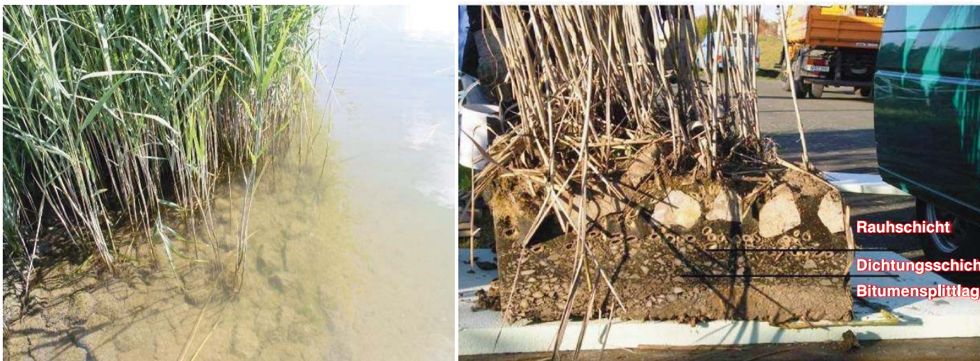
Abb. 4: Schilfbewuchs der Asphaltichtung
