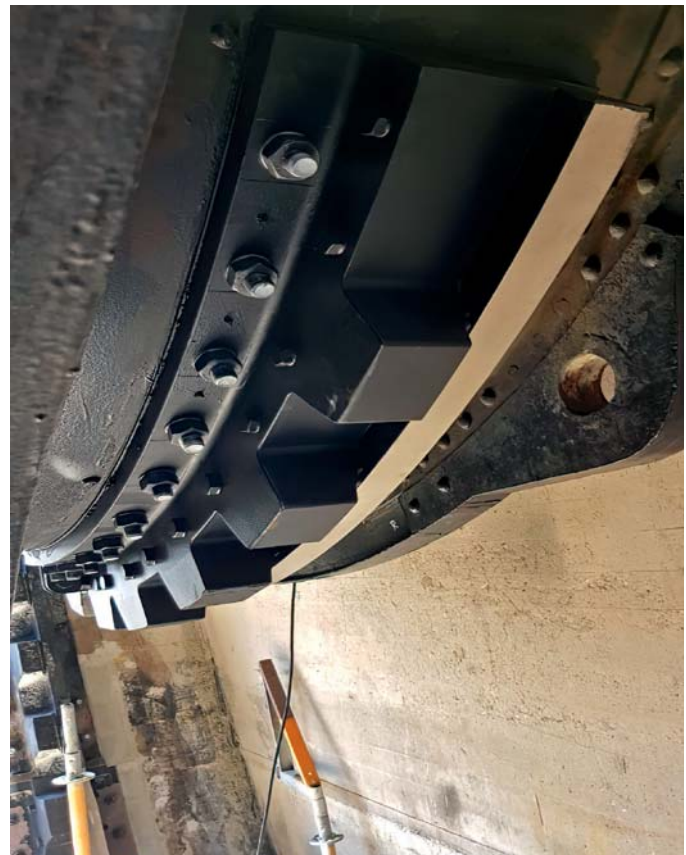
Bild 18: Neuer Zahnkranz nach der Montage auf der Walze
