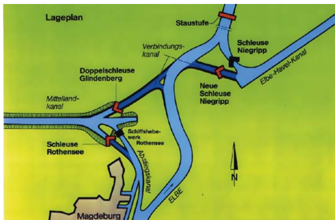
Abb. X-3: Übersichtsskizze zu der nicht ausgeführten Alternativvariante mit Staustufe bei Heinrichsberg/Niegripp
