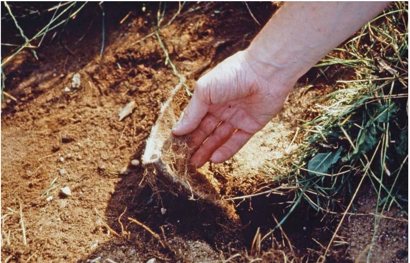
Abb. 9: Durchwuzelte geotextile Filter an Aufgrabungsstellen an der Aller bei Maklendorf (Aller-km 37)
