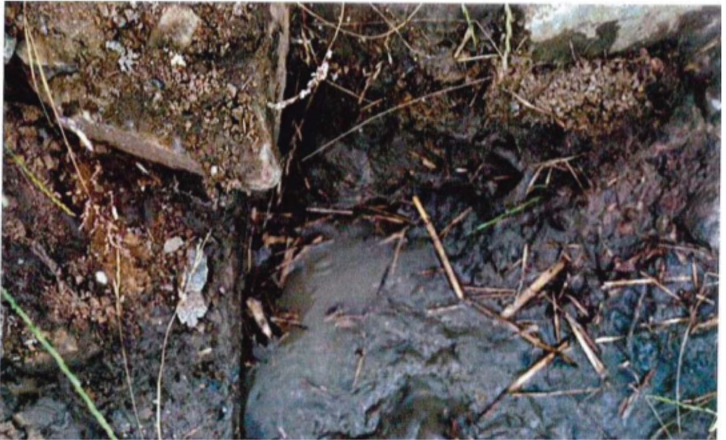
Abb. 10: Sediment ca. 60 cm unter OK Steinschüttung bei MLK km 115,495 aus (43)
