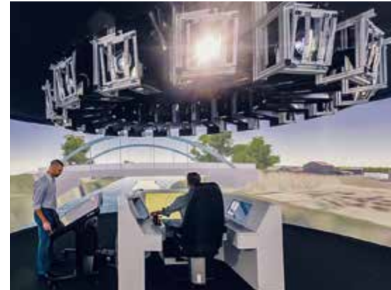
Im Duisburger VeLABi wird am Hightech-Simulator das automatisierte Fahren in der Binnenschifffahrt erforscht und entwickelt. (Foto: DST Duisburg)
