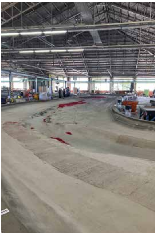
Versuchshalle mit Modellierung der Rheinstrecke
