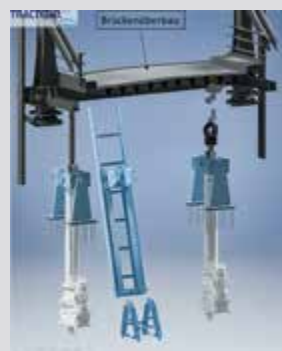
Bild 9: Anschlag und Verfahren des EHZ mit Hebemittel
