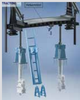
Bild 7: Verfahren von Verkehrslage in Wartungslage (Hubhöhe ca. 1,70 m)
