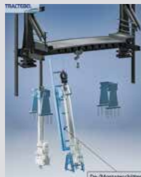
Bild 10: Verfahren des DE-/Montageschlittens mit EHZ in obere Stellung
