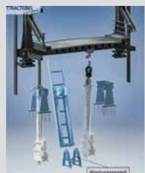
Bild 9: Anschlag und Verfahren des EHZ mit Hebemittel
