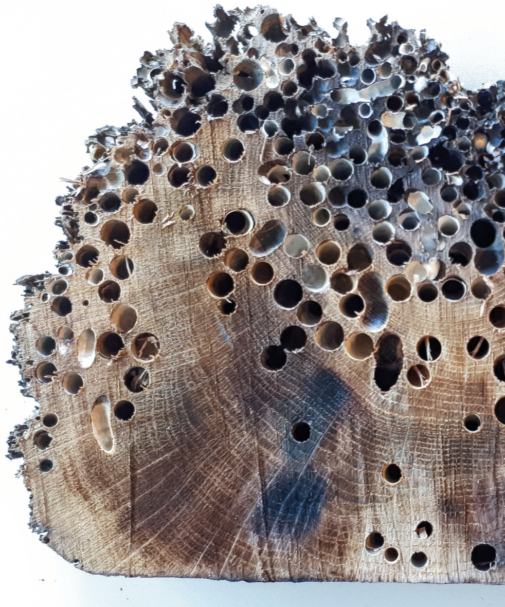
Eichenbalken einer Dichtung von der Bohrmuschel zerfressen und nun mit unzähligen Löchern versehen.
