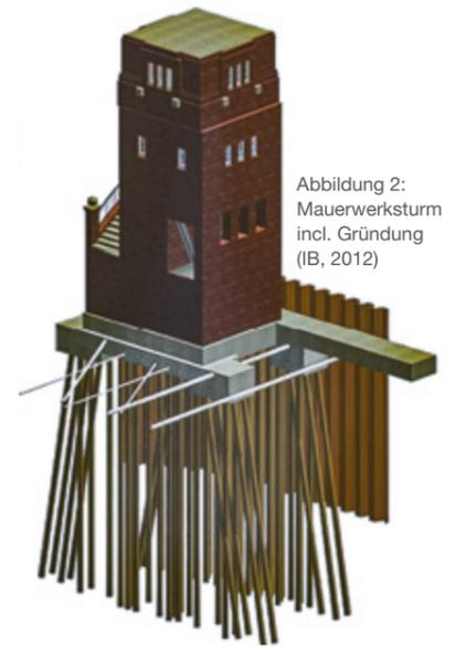
Abbildung 2: Mauerwerksturm incl. Gründung (IB, 2012)
