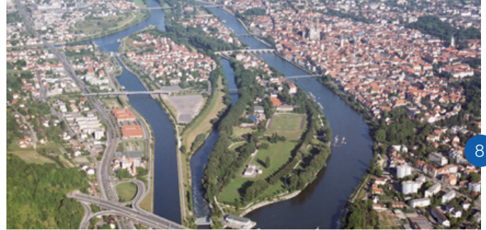
Zum Erhalt der Steinernen Brücke in Regensburg wurde der Schleusenkanal (links) über den Protzenweiher geführt. (Foto Wolf 1988 / Archiv WSA Regensburg)
