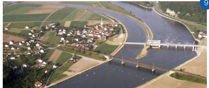
Aufgrund enger Krümmungen sowie der Heilquellen in Bad Abbach wurde ein langer Schleusenkanal von Poikam nach Oberndorf errichtet. (Foto Wolf 1979 / Archiv WSA Regensburg)
