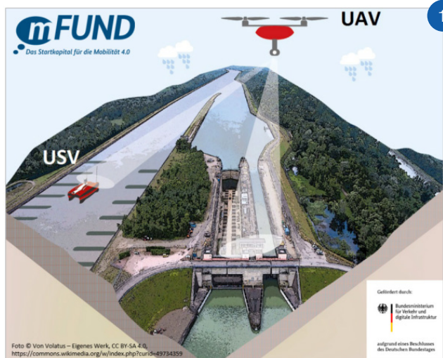
Bild 1: Schematische Darstellung der Funktionsweise des Tandemsystems
