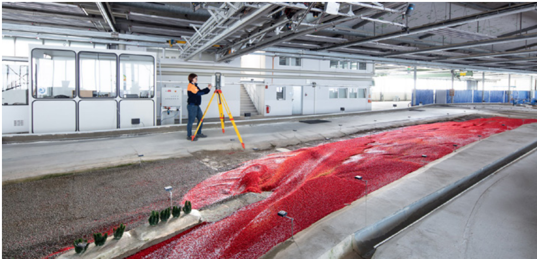
Bild 5: Gegenständliches Modell der Isarmündung und des Isarschüttkegels im Maßstab 1:50 mit beweglicher Modellssole (Blick aus der Isar nach unterstrom). Zum Einsatz kam ein Gemisch aus farbigen Kunststoffgranulaten als Geschiebeersatzmaterial.
