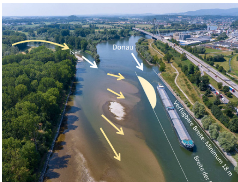
Bild 4: Blick nach oberstrom auf Isarmündung und Isarschüttkegel während einer Niedrigwasserphase (Fahrrinnenränder, Geschiebetransportpfade sowie Einschränkung der Fahrrinne lediglich skizzenhaft dargestellt)
