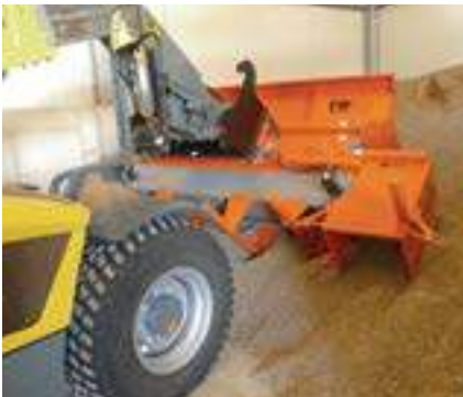
Die Optimas Finliner Materialverteilschaufel wird an einen Radlader angebaut. Damit kann das Material aufgenommen werden.
