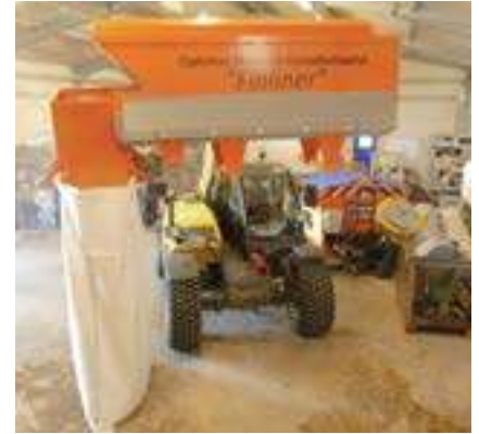
Der Big Bag wird an die Haltehaken der Finliner angehängt und zum Einsatzort gefahren.
