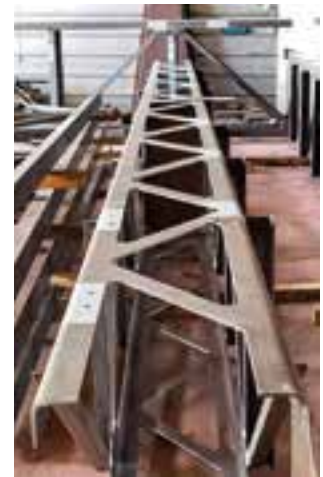
Abb. 13: Fahrwagen, gekantete Fachwerkträger, Quelle WSA
