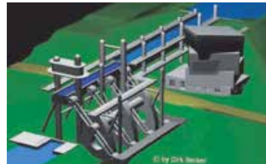
Abb. 10 – Computer-Animation von 2012 eines Hebewerks-Vorschlages von Dirk Becker (Halle/Saale) für 22m Hubhöhe zwischen Saale-Anschluss und Saale-Leipzig-Kanal (früher: Elster-Saale-Kanal);* *(mit freundlicher Genehmigung des Autors) [Es handelt sich hierbei um ein Senkrechtbewerk mit Waagebalken und senkrechter Zwangsführung von Trog und Gegengewicht, wobei die Waagebalken trotz der ständig hohen Biegebeanspruchung quer ausfahrbar sein müssen, was es in dieser Art noch nicht gegeben hat.]
