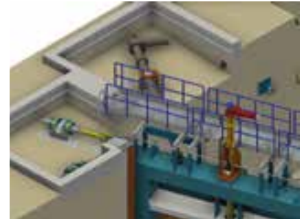
Bild 5: Untertorantrieb mit Antrieb Entleerungsschütz
