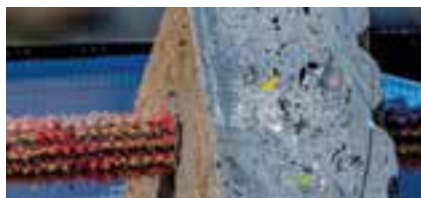
Beim genauen Hinsehen sind die bunten Kunststoffreste von Waschmittel-Flaschen oder Shampoo-Behältern noch deutlich im gepressten Baumaterial zu erkennen. © kairospress
