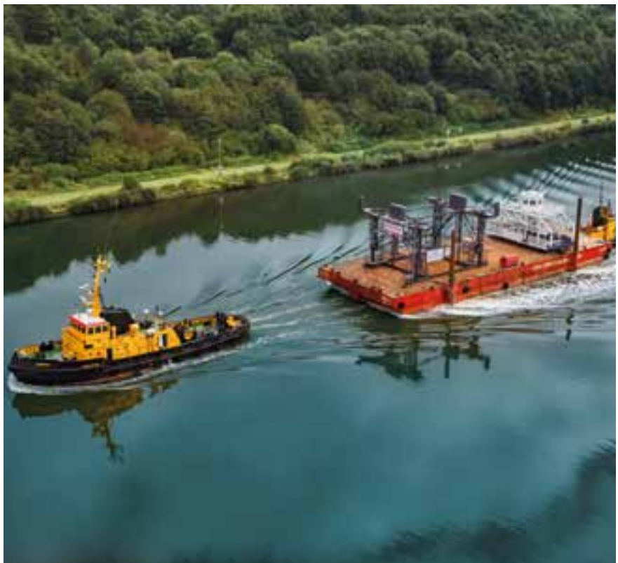
Abb. 14: Transport Fahrwagen und Fahrbühne auf Ponton im Nord-Ostsee-Kanal, Quelle WSA
